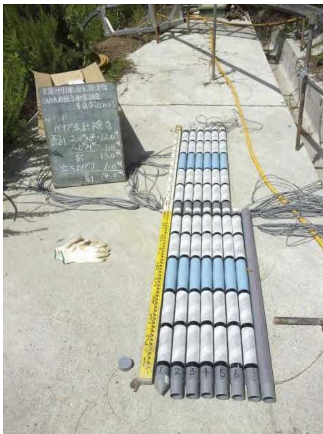
パイプ歪計検尺(全長14m)
