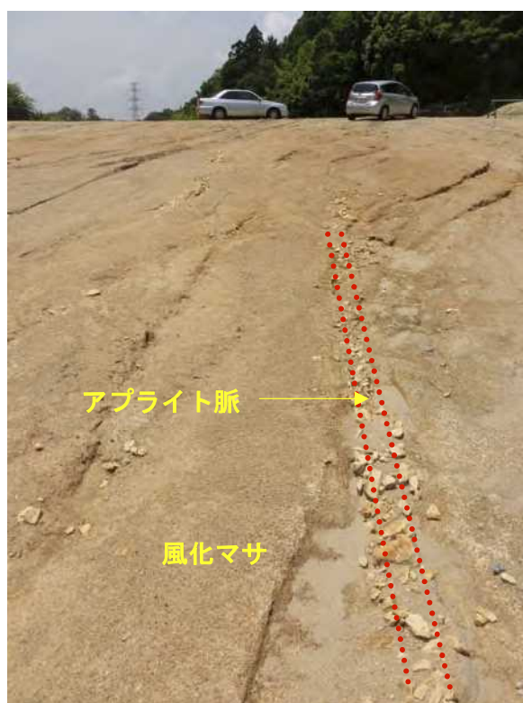
（写真 A）風化マサの中に残存する角礫化した細粒花崗岩（アプライト）脈
