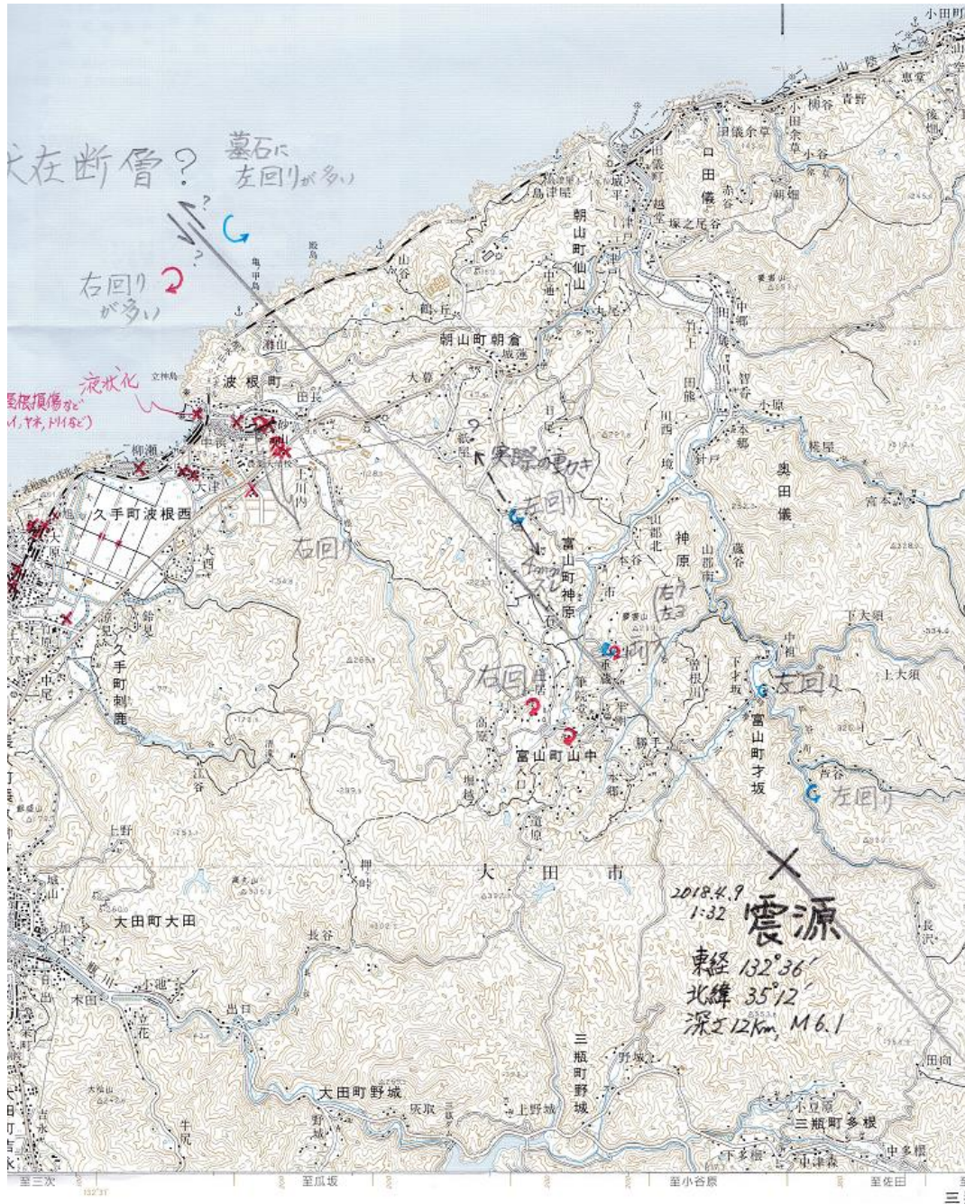
図1. 大田市東部の地形図に記した被害箇所と墓石の回転痕跡から推定される伏在断層 (国土地理院5万分の1地形図「石見大田」を使用)
