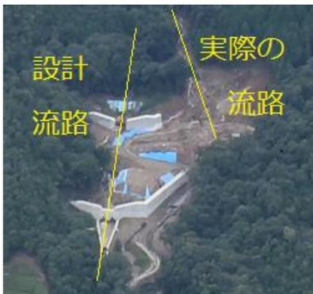
前回9月21日に大急ぎで建設中の砂防ダムの様子を見たときの感想は、①上の崩落痕から想像するほど下の被害は大きくないのではないか、②生起した土石流はダムの設計とは異なる流路をとったのではないかと（左写真）
