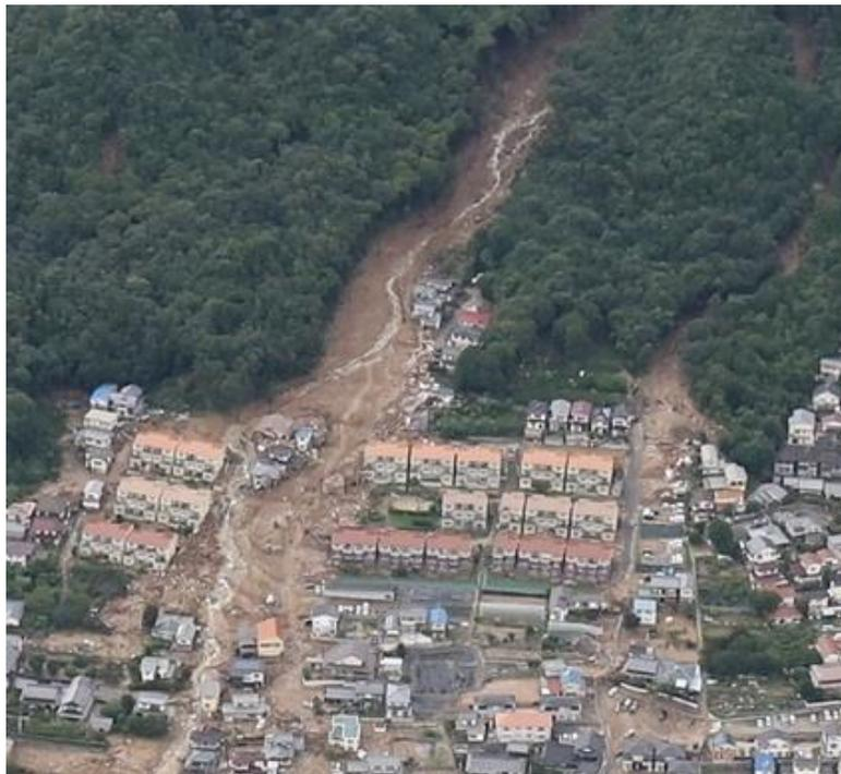
土石流痕が幅広く長いのだ。そして現場における住宅の破壊のすさまじさ。運ばれてきた岩の大きさ(数トンはある大岩がごろごろ)。土石流の到達した高さ(県営住宅の3F階段近くにまで到達した)。原状をとどめないほどにつぶれた車の残骸の多さ。失われた人命の多さ(三丁目全体では41名)。惨状を写した映像、写真は被災者の気持ちを慮(おもんばか)って、マスコミでも最低限のものしか流していないと思う。私も、土石流の痕跡は山の中でしっかりとカメラを向けるが、人の居るところではカメラを取り出すことさえ、はばかられた。本当は、しっかりと記録に残すべきだと思う。
